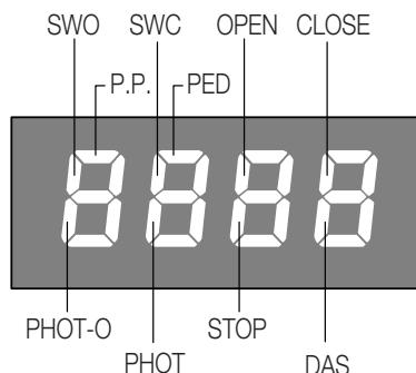
Les entrées N.F. sont représentées par les segments verticaux. Les entrées N.O. sont représentées par les segments horizontaux.
