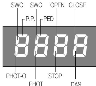
Den normalerweise geschlossenen Eingängen entsprechen die vertikalen Segmente.
