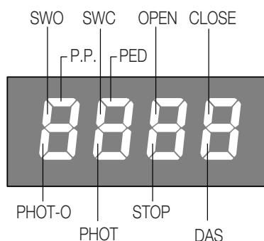
Wejścia N.Z. wyświetlane są przez segmenty pionowe. Wejścia N.O. wyświetlane są przez segmenty poziome.
